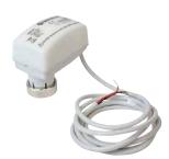
Attuatore per comando valvola miscelatrice R298, R298N e valvole di regolazione indipendente della pressione (PICV) R206A, R206AM. Alimentazione 24 V. Funzionamento in combinazione con termoregolazione KLIMAbus Giacomini. Condizioni temperatura ambiente di funzionamento 0÷55 °C.
