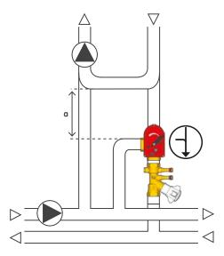
**fig. 5.18**Esempio di installazione del circuito di iniezione in uno spazio ridotto.
