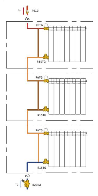
**fig. 3.24**Installazione con circuito monotubo e valvola R206A con valvole radiatore a regolazione manuale
