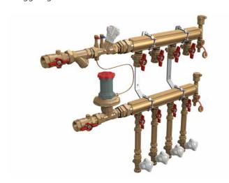
**fig. 3.43**Collettore per installazione per piano con regolazione generale della pressione differenziale, bilanciamento statico individuale e misurazione individuale dei consumi energetici per unità abitativa
