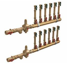
**fig. 3.46**Gruppi collettori per installazione per piano con regolazione generale della pressione di alimentazione e misurazione individuale dei consumi di ACS e AFS per ogni unità abitativa
