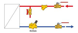
**fig. 3.23**Installazione della valvola a valle di un'unità a due tubi (ad esempio un ventilconvettore)
