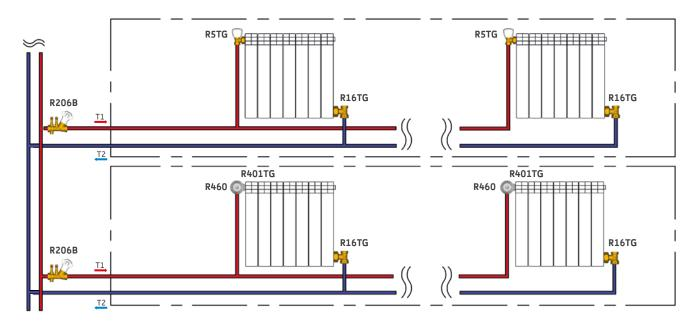
fig. 3.2 Applicazione della valvola R206B in un impianto con radiatori bilanciato
