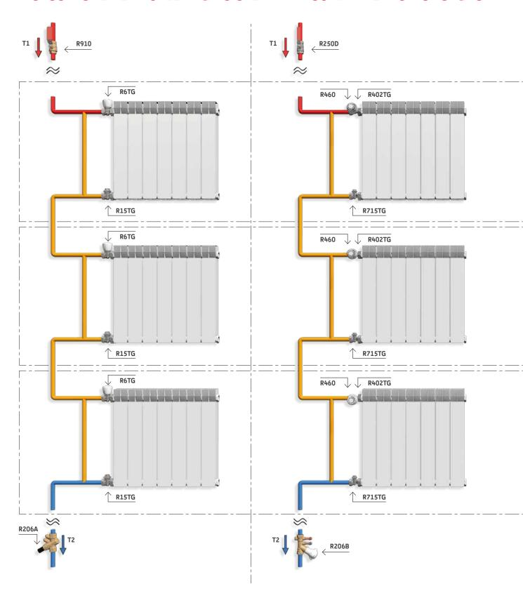
Controllo automatico della portata effettuato con la valvola di bilanciamento dinamico R206A ed intercettazione del flusso attraverso valvola a sfera.
