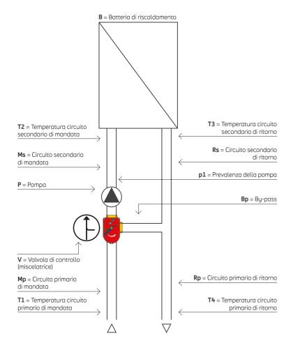
**fig. 5.6** Tipico schema di un circuito di miscelazione
