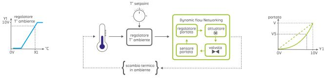
**fig. 3.63**Anello di controllo di una valvola a sei vie con bilanciamento dinamico
