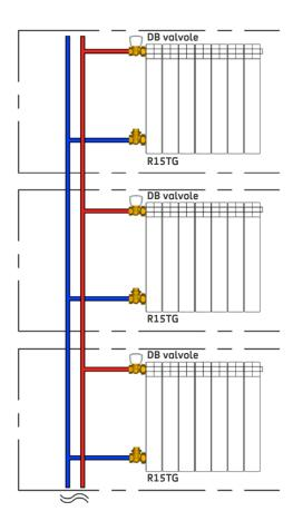
**fig. 3.67**Applicazione a due tubi tipo per valvola radiatore serie DB
