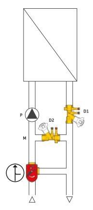
D1 limita il flusso totale mentre D2 regola il volume di miscelazione costante. D2 viene prima aperta e poi chiusa leggermente in modo da evitare che la temperatura, nel punto di miscelazione M, superi il valore massimo.
