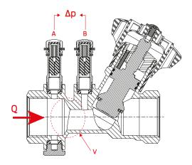
**fig. 3.8**Misurazione della perdita di carico sul Venturi con orifizio calibrato V
