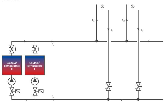
**fig. 1.8**Due generatori (caldaie/refrigeratori) in parallelo
