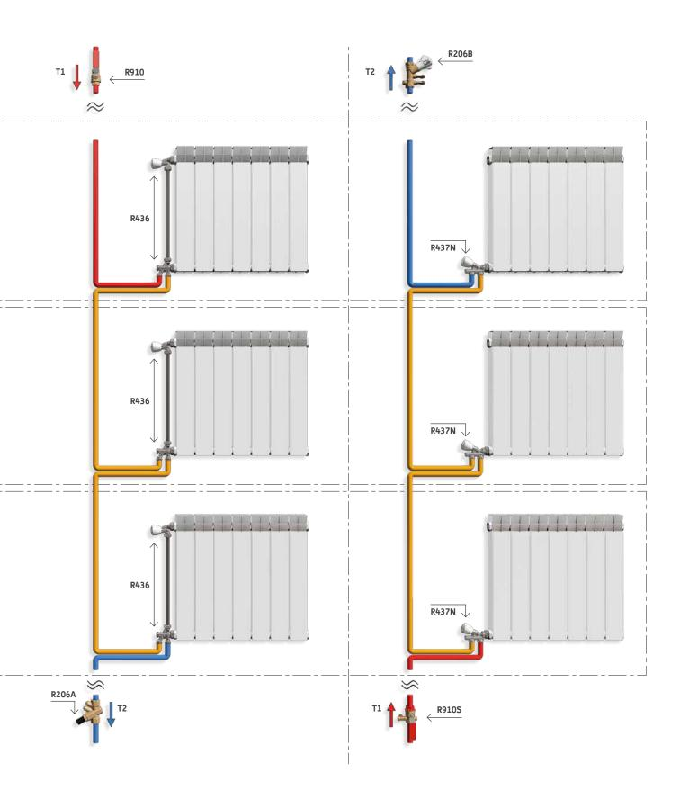
Controllo automatico della portata effettuata con valvola di bilanciamento R206A e intercettazione del flusso tramite valvola a sfera.
