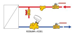
**fig. 3.31**Layout di Installazione tipica della valvola R206AM in un impianto di distribuzione a due tubi
