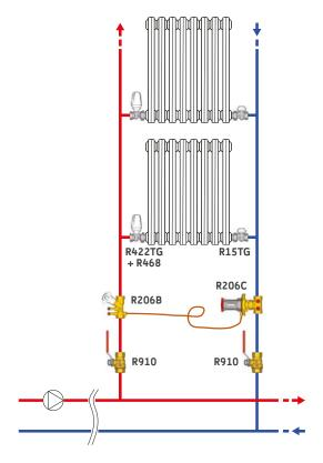
**fig. 3.40**Situazione 1: applicazione con attuatori proporzionali (teste termostatiche)
