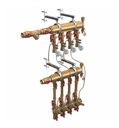
**fig. 3.44**Gruppo collettore per installazione a pavimento con regolazione individuale della pressione differenziale e misurazione dei consumi energetici per ogni unità abitativa
