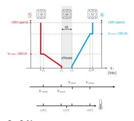
**fig. 3.64**Diagramma del segnale di controllo di una valvola a sei vie con bilanciamento dinamico
