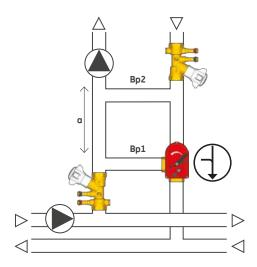
**fig. 5.15**Distanza tra i due by-pass di un circuito a iniezione
