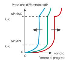
**fig. 3.71**Regolazione di funzionamento dei collettori con controllo dinamico della portata
