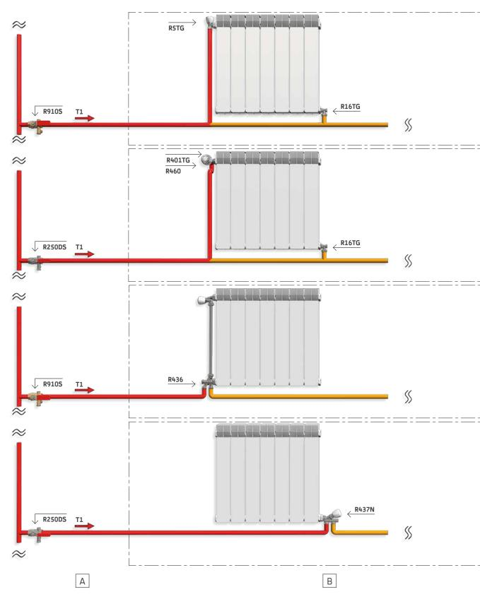
Controllo manuale della portata effettuato con la valvola di bilanciamento statico R206B ed intercettazione del flusso attraverso valvola a sfera.
