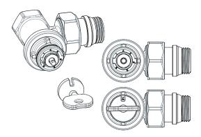
**fig. 3.68**Regolazione della portata con chiave di regolazione
