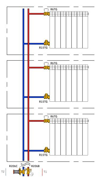
Questa configurazione permette alla valvola di controllo pressione differenziale R206C di mantenere la pressione differenziale sul valore impostato (valore di progetto) entro la sezione dell'impianto da bilanciare.
