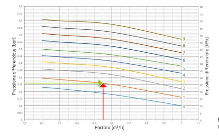
A titolo esemplificativo, consideriamo un'utenza con portata di 600 l/h e pressione differenziale desiderata in linea con le condizioni di progetto di 25kPa. In base ad entrambi i parametri, scegliere la dimensione della valvola da 1/2" - R206CY103 e la scala di regolazione alta "H".
