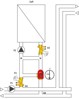
$D_2^2$  = Valvola di bilanciamento secondaria Il circuito di iniezione viene utilizzato quando la batteria è installata sul circuito parallelo rispetto alla tubazione di alimentazione, a
