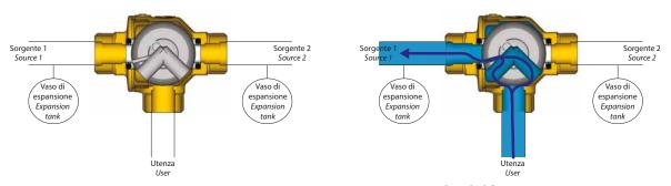
**fig. 3.60**Sistema di protezione da sovrappressioni che allo stesso tempo evita la contaminazione incrociata e le perdite di energia
