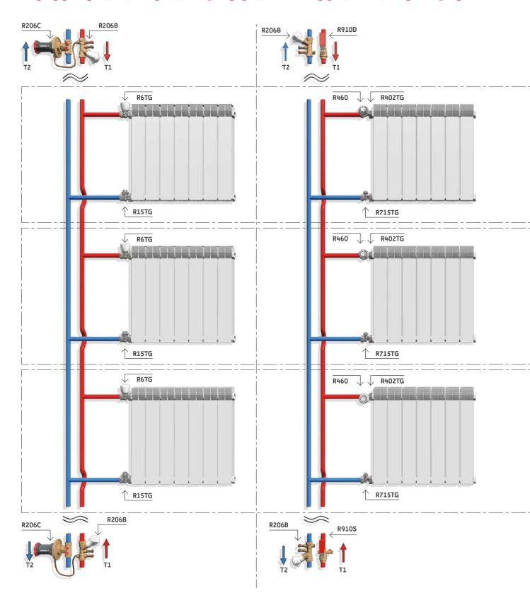
Controllo manuale della portata con valvola di bilanciamento statico R206B e controllo automatico della pressione differenziale operato tramite valvola di regolazione della pressione differenziale R206C.
