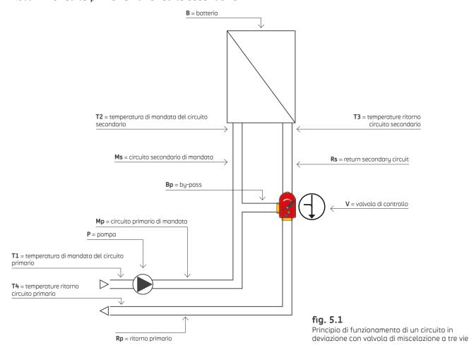
Se la valvola (di controllo) è chiusa, il flusso totale generato dalla pompa P nella mandata del circuito primario viene deviato nel ritorno di quest'ultimo. Per ogni posizione intermedia, una certa quantità con temperatura T=1 circolerà nel circuito secondario (a valle della miscelatrice).
