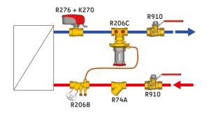
**fig. 3.36** Installazione tipo di una valvola R206C
