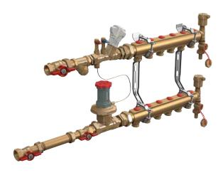
**fig. 3.45**Gruppo collettore per installazione nell'unità abitativa con regolazione generale della pressione differenziale e bilanciamento statico per ogni circuito mediante detentori integrati
