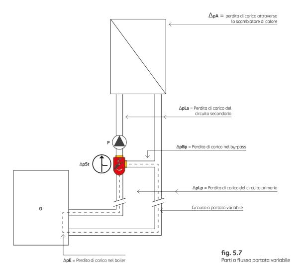
Come indicato in fig. 5.7, quando la valvola di controllo è completamente aperta, la pompa spinge l'acqua attraverso la batteria, la tubazione di ritorno, il boiler (caldaia), la tubazione di mandata e la valvola stessa. La sezione a portata variabile si trova nel circuito primario.
