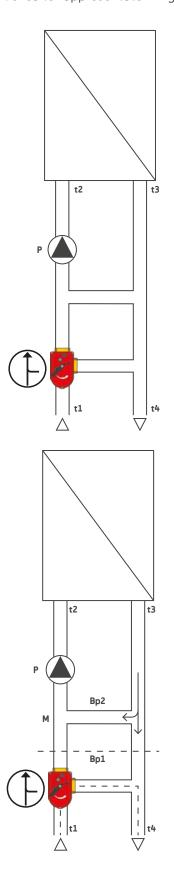
**fig. 5.9**Principio di funzionamento di un circuito miscelato con differenza di temperatura T<sub>mandata primario</sub> - T<sub>mandata secondario</sub>
