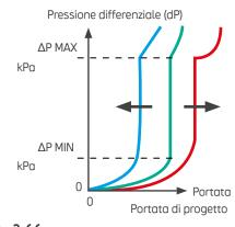
**fig. 3.66**Regolazione e funzionamento di una valvola termostatica per radiatori serie DB con controllo dinamico della portata
