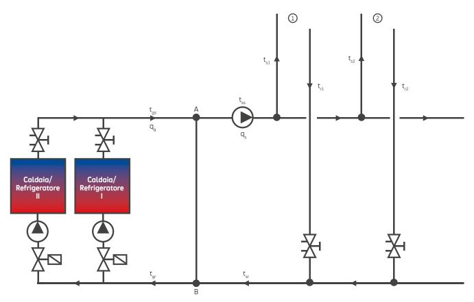
**fig. 1.9** Separazione con un by-pass
