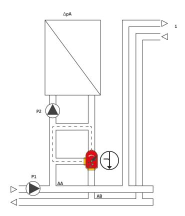
**fig. 5.13**Parti a flusso variabile di un circuito a iniezione 1 = Tubazioni verso alter unità terminali AA = Connessione mandata AB = Connessione ritorno
