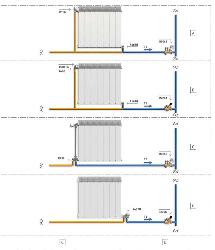
Controllo manuale della portata effettuato con la valvola di bilanciamento statico R206B ed intercettazione del flusso attraverso valvola a sfera.
