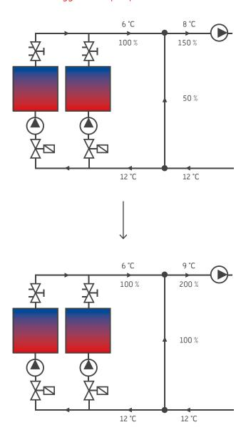
**fig. 1.11** Incrementare la prevalenza della pompa secondaria
