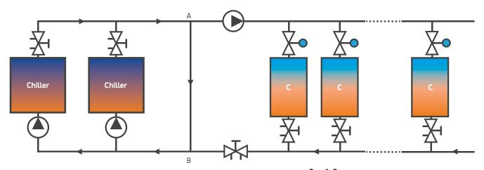
**fig. 1.2**Esempio di un sistema di distribuzione a flusso variabile
