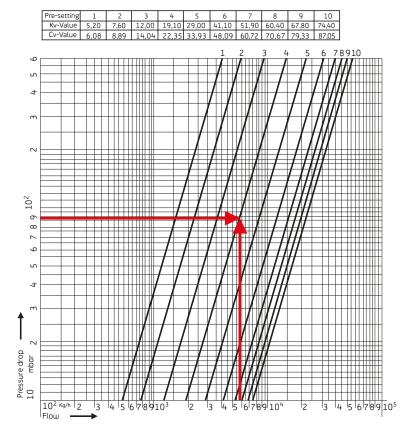
**fig. 3.18**Come selezionare la regolazione della valvola (l'esempio fa riferimento alla misura DN65)
