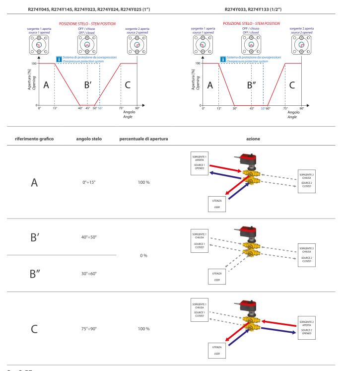
**fig. 3.57** Diagramma di apertura della valvola
