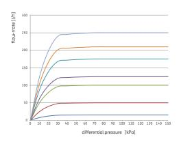
**fig. 3.74**Diagramma per la regolazione dei collettori di distribuzione con controllo dinamico della portata
