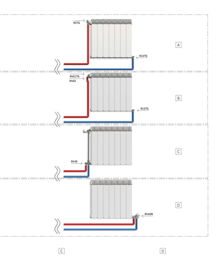
Controllo automatico della portata effettuata con valvola di bilanciamento dinamico R206A e intercettazione del flusso tramite valvola a sfera.
