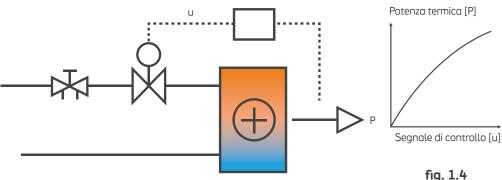
**fig. 1.4**Caratteristica del circuito
