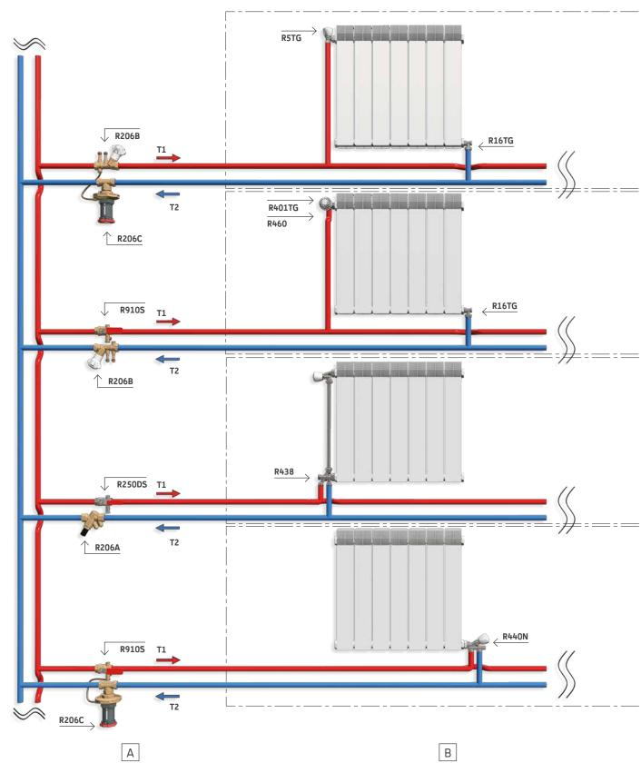
Controllo manuale della portata con valvola di bilanciamento statico R206B e controllo automatico della pressione differenziale operato tramite valvola di regolazione della pressione differenziale R206C.
