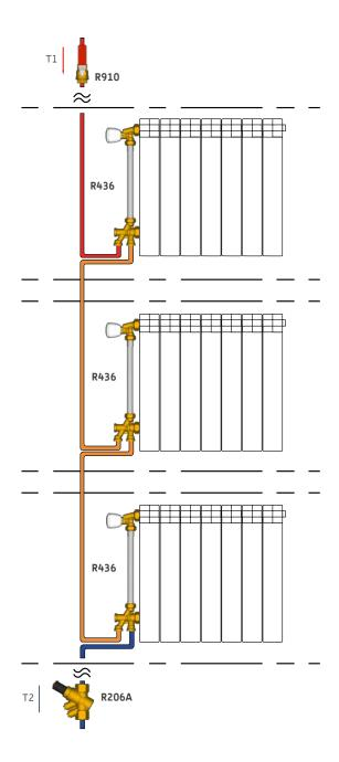
**fig. 3.25**Installazione con circuito monotubo e valvola R206A con valvole radiatore termostatiche
