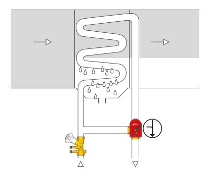
**fig. 5.5**Applicazione nel circuito in deviazione in una batteria di raffredamento per deumidificazione
