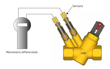
**fig. 3.28**Misurazione della pressione differenziale
