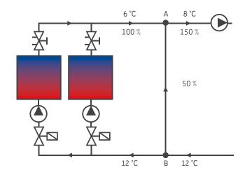
**fig. 1.10**Problemi di incompatibilità in riscaldamento e raffrescamento
