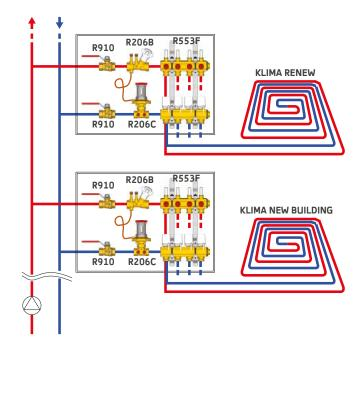
**fig. 3.41**Situazione 2: applicazione con attuatori "on-off" (teste elettriche R473, R473M)
