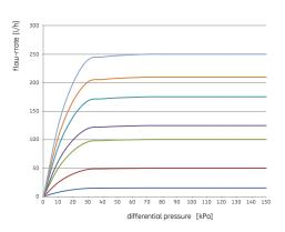
**fig. 3.69**Diagramma per la regolazione delle valvole termostatiche per radiatore - serie DB
