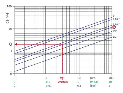
**fig. 3.9**Diagramma portata — pressione differenziale per la valvola di bilanciamento statico R206B
