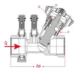
**fig. 3.6**Sezione della valvola R206B
